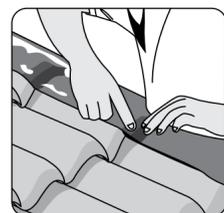
03. Após retirar a película plástica protetora, cole a Tabeira, alinhando-o bem. Cole a outra extremidade nas cristas das telhas e depois molde-a com os dedos, completando a fixação.
