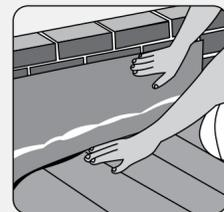
03. Meça o comprimento necessário de Ruflex e corte-o na medida. Cole-o sobre a parede, tomando cuidado para deixá-lo bem alinhado.
