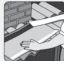
02. Retire a película plástica que protege uma das faixas adesivas, utilizando a linha picotada.
