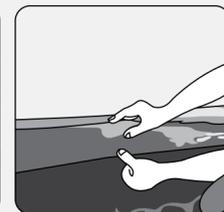
06. Para acabamento superior, cole outro Ruflex sobre o que já foi aplicado, usando uma sobreposição de 2 a 3 cm. Cole a outra extremidade na face de trás da Platibanda.
