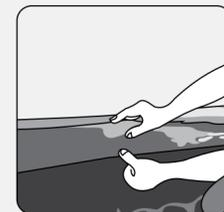
05. O Ruflex molda-se perfeitamente ao perfil dos diferentes tipos de telhas. Aplique o Veda Rufos e Calhas Tégula na extremidade superior do Ruflex, para uma melhor vedação (veja ilustração abaixo).
